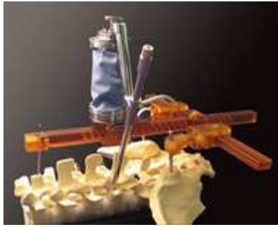
OP-Roboter SpineAssist setzt punktgenau die Bohrhülsen ein
